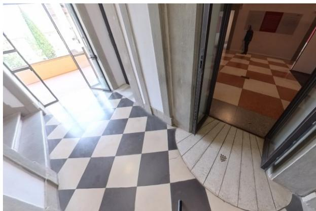
Ingresso interno percorso museale primo piano accessibile tramite rampa lunga 107 cm e con pendenza 6%
